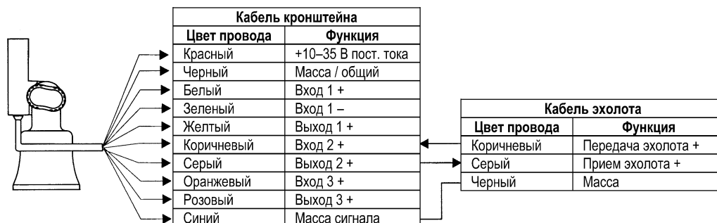
Рис. 4.7. Подключение эхолота к картплоттеру с быстросъемным кронштейном
