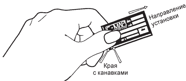
Рис. 2.6.1а. Установка картриджа C-CARD (I)
