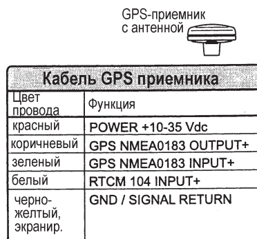
Рис. В.2. Подключение GPS приемника
