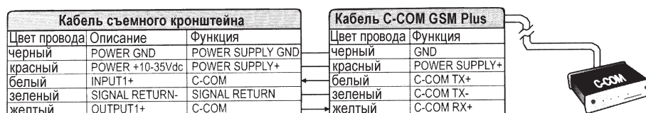
Рис. 2.5.4а. Подключение модема к порту 1
