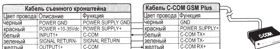
Рис. 7.4h. Подключение модема к порту 1
