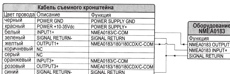
Рис. 2.5.2а. Подключение NMEA оборудования к порту 1 модели Sky X5 Fish
