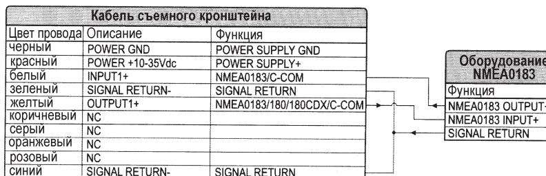
Рис. 7.4g. Подключение NMEA оборудования к порту 1 модели Compact X5 Fish
