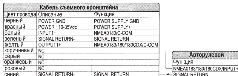
Рис. 2.5.2б. Подключение авторулевого к порту 1 модели Compact X5 Fish
