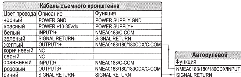
Рис. 7.4c. Подключение авторулевого к порту 1 модели Sky X5 Fish
