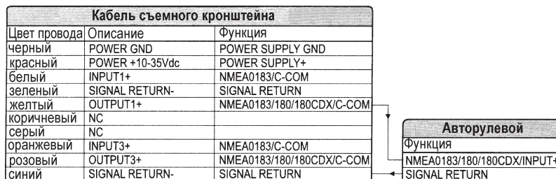
Рис. 2.5.2а. Подключение авторулевого к порту 1 модели Sky X5 Fish
