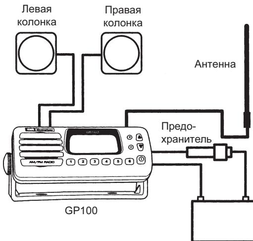
1. Подсоедините красный провод со встроенным предохранителем к положительной клемме аккумулятора или к контакту +12 В судовой сети.
