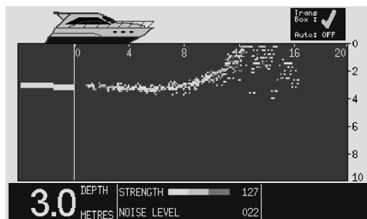
Вид экрана прибора в режиме впередсмотрящего эхолота
