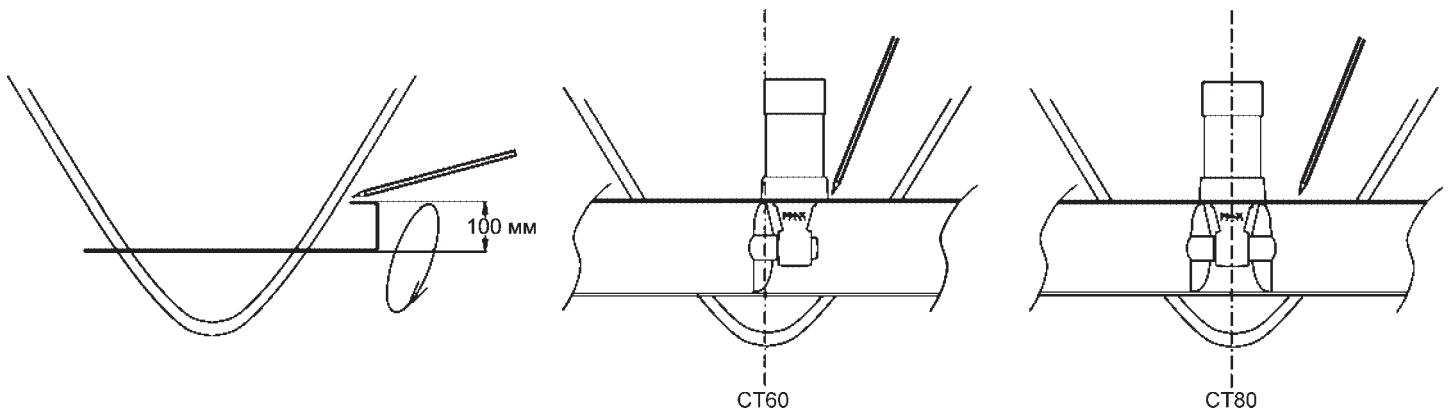
Снова вставьте тоннель в корпус и закрепите его изнутри и снаружи при помощи стеклопластика. Тщательно заполните все пространство между тоннелем и корпусом.
