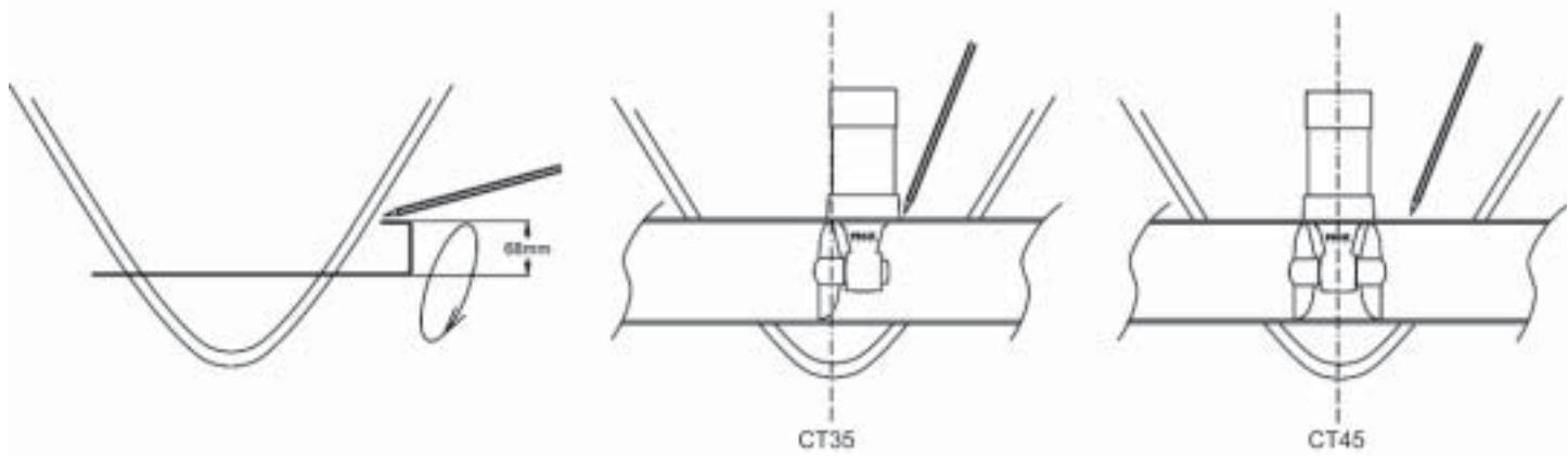
Снова вставьте тоннель в корпус и закрепите его изнутри и снаружи при помощи стеклопластика. Тщательно заполните все пространство между каналом и корпусом.
