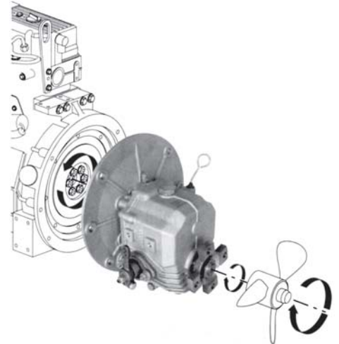
Рис. 1. Направление вращения валов редуктора и двигателя
