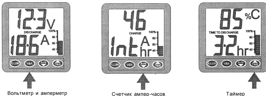
Рис. 2. Рабочие режимы контрольного прибора BM-1
