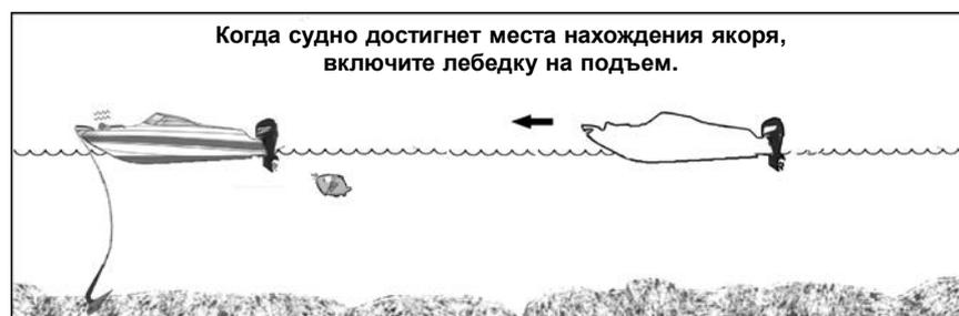
Примечание: Брашпиль предназначен исключительно для подъема якоря, а не для подтягивания или швартовки судна.
