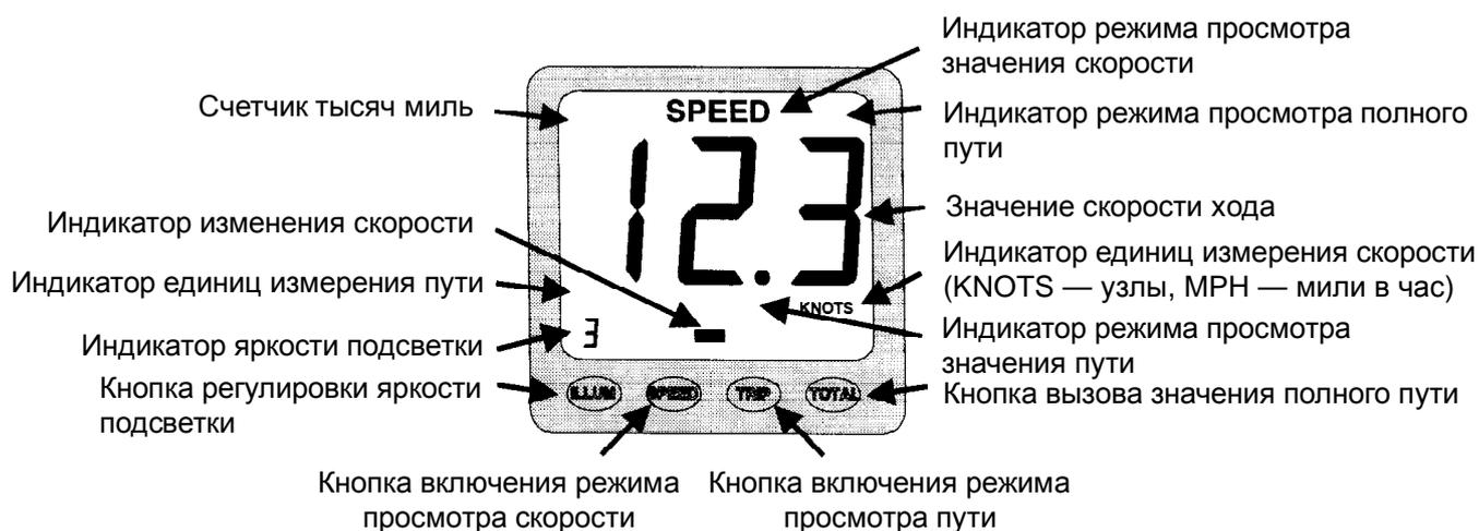
Рис. 3 Вид экрана прибора в рабочем режиме
