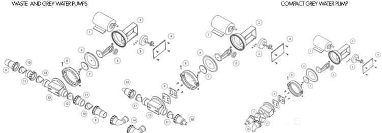
EXPLODED VIEW / SPARE PART LIST: 01) 6000108712-24 MOTOR 12/24 V. 05)-07) 8700001105 PISTON ROD. 06)-10)-12) 8700001106 GASKET KIT 08) 8700001108 FIXING CLAMPS 09)-10)-11)-12)-13)-14) 8700001110 WASTE PUMP GROUP
