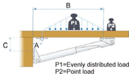
Rakego - это телескопическая алюминиевая опора для мест, где требуется высокое качество. Опору можно использовать несколькими способами. Анодированный (20 мкм) алюминий (AA6063).
