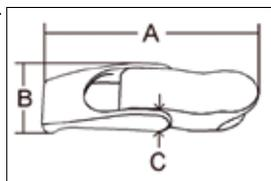
Фиксатор люка, (прочность фиксации 8 кг). A = 22,5 мм, B = 16 мм, C = 32 мм, D = 20 мм, F = 21 мм.
