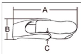
Фиксатор люка AISI316, эксцентриковая ответная часть. A = 68 мм, B = 20 мм, C = 13 мм.
