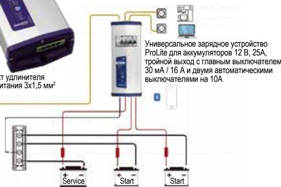
Универсальное зарядное устройство ProLite для аккумуляторов 12 В, 25А, тройной выход с главным выключателем 30 мА / 16 А и двумя автоматическими выключателями на 10А
