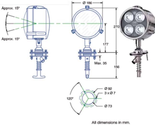
9514039220 180CB-LED 10-32 VCD 20 W Ø 180 мм
