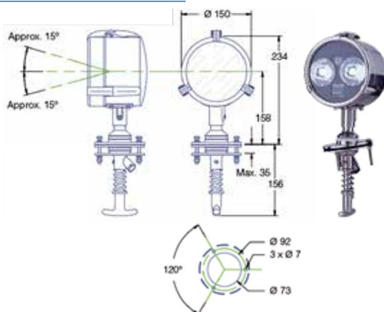
9514039230 150CB-LED 10-32 VCD 10 W Ø 150 мм
