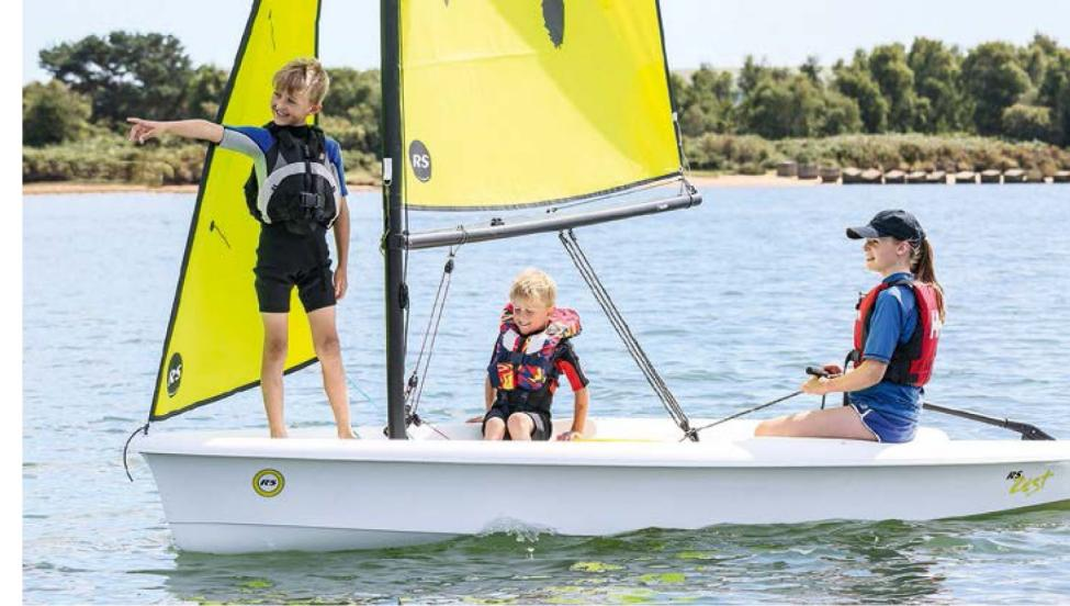
И напоследок два слова о парусном вооружении новинки. В стандартную комплектацию входит грат из дакрона площадью 5,7 кв. м. Он не имеет липкоза и надевается на мачту «чулком». Имеется возможность взять рифы. Дакроновый стаксель площадью 1,2 кв. м в базовую комплектацию не входит.
