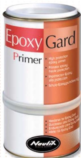
Ерохугард – это эпоксидный грунт нового поколения, обеспечивающий надежную защиту поверхности от проникновения влаги. Предназначен для защиты подводных частей судна. Рекомендуется наносить 1 слой для лучшего приставания необрастающей краски или 5 слоев для защиты от осмоса. Для защиты от осмоса и ремонта его последствий можно также применять вместе со смолой Impregard.
