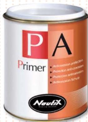
Грунт РА наносится очень легко при любых погодных условиях (температура окружающего воздуха должна быть выше  $0^{\circ}\text{C}$ ). Система IA-РА гарантирует долговременную защиту килля и корпуса из стали от коррозии в морской среде. Грунт РА также можно наносить непосредственно на сталь. Для защиты от коррозии наносите не менее 5 слоев грунта РА. Перед покрытием необрастающей краской грунт шлифовать не надо.
