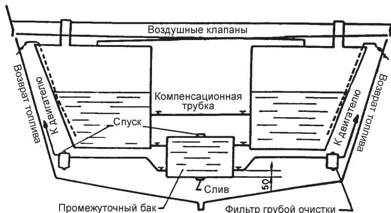
Рис. 3. Установка двух двигателей с двумя баками
