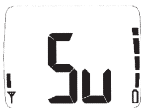
После успешного связывания загорается индикатор Su.
