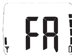
После неудачного связывания загорается индикатор FA.
