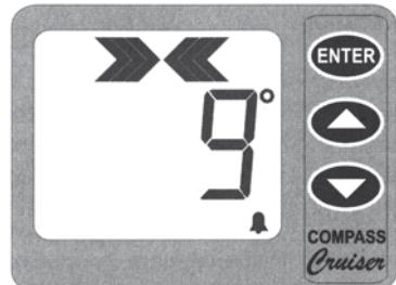
Рис. 5. Порог срабатывания сигнализации  $\pm 9^\circ$
