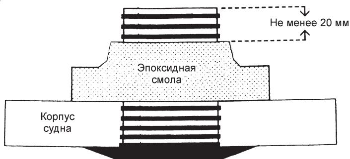
Вытащив судно на берег, просверлите в днище сквозное отверстие диаметром 42 мм и закрепите в нем шахту датчика, используя стандартные средства для заделки корпуса. При этом не рекомендуется пользоваться замазкой — лучше возьмите подходящий силиконовый герметик.
