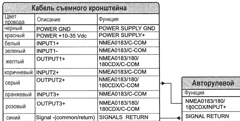
Рис. 2.5.2. Подключение авторулевого к порту 2
