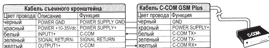
Рис. 2.5.4а. Подключение модема к порту 1
