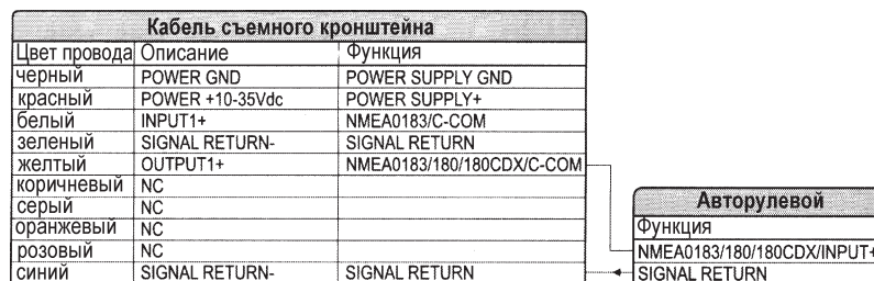
Рис. 7.4d. Подключение авторулевого к порту 1 модели Compact X5 Fish
