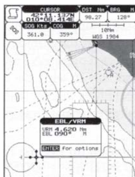
Рис. 4.3.1. Электронный указатель направления и кольцо дальности (EBL/VRM)
