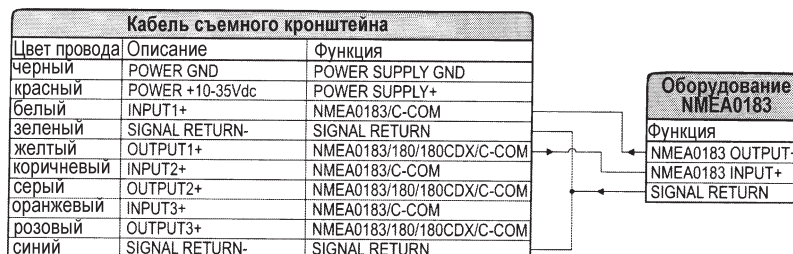
Рис. 7.4e. Подключение NMEA оборудования к порту 1 моделей Sky X5 и Compact X5
