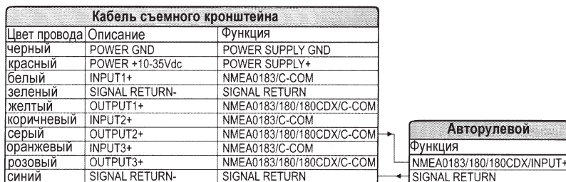
Рис. 2.5.2. Подключение авторулевого к порту 2 моделей Sky X5 и Compact X5
