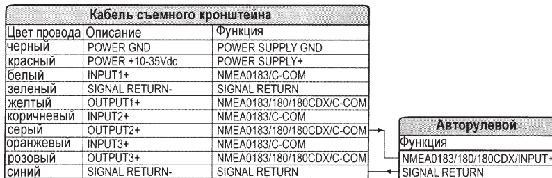
Рис. 7.4b. Подключение авторулевого к порту 2 моделей Sky X5 и Compact X5
