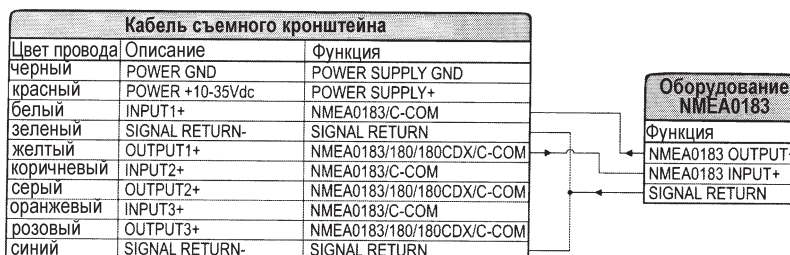
Рис. 2.5.2. Подключение NMEA оборудования к порту 1 моделей Sky X5 и Compact X5
