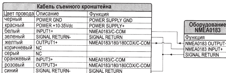
Рис. 7.4f. Подключение NMEA оборудования к порту 1 модели Sky X5 Fish
