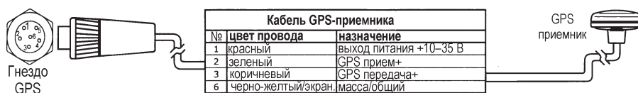
Подключение GPS приемника к порту 3
