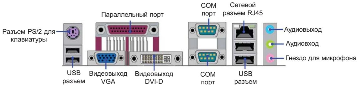
Выход DVI находится на задней панели корпуса видеопроцессора (см. рисунок). Разъем кабеля следует закрепить двумя винтами для защиты соединения от вибрации. Другой конец кабеля подключается к дисплею.
