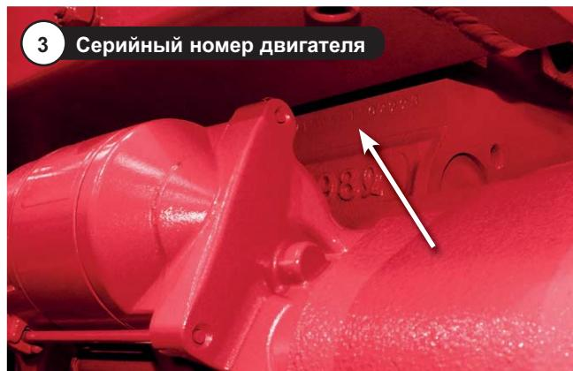
Серийный номер двигателя указан на табличке, расположенной на крышке клапанного механизма. Он также выбит на катере двигателя над стартером и под теплообменником со стороны правого борта.
