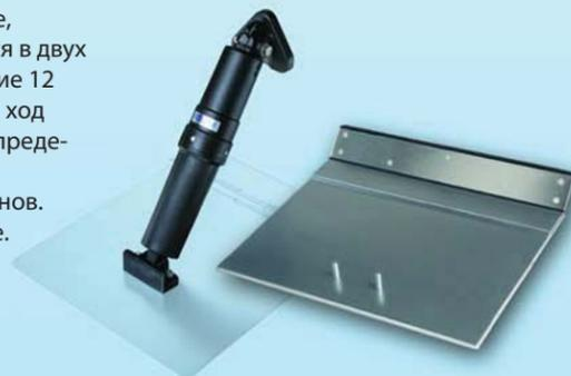
**Транцевые плиты.** Изготавливаются из листовой нержавеющей стали калибра 12 марки 304 с петлями на штифтах. Имеются все стандартные размеры, а также возможно изготовление плит других размеров и форм по заказу. Также имеются новые запатентованные плиты из сплава 6005-T5 с полипропиленовыми петлями большинства стандартных размеров и на заказ. Плиты из сплава не могут иметь загнутые вверх или вниз края.
