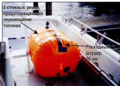
2 стяжных ремня, предотвращающих перемещение топлива Расходный штуцер, 38 мм 8 креплений для тросов, рассчитанных на нагрузку по 450 кг каждое Сливная горловина, 20 мм Двойная оболочка обеспечивает повышенную прочность Размеры: длина: 985 мм ширина: 915 мм высота: 845 мм масса: 10.4 кг
