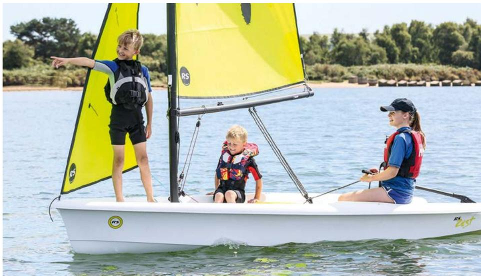
И напоследок два слова о парусном вооружении новинки. В стандартную комплектацию входит грот из дакрона площадью 5,7 кв. м. Он не имеет ликпаза и надевается на мачту «чулком». Имеется возможность взять рифы. Дакроновый стаксель площадью 1,2 кв. м в базовую комплектацию не входит.
